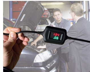
Spannungs- und Stromanzeige bei der Erhaltungsladung
