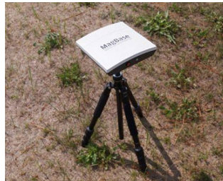
Messstation für stationäre Feldmessungen
