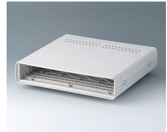
A0214170 EUROPA-GEHÄUSE 42 TE, o. Griffb. ABS (UL 94 HB) grauweiß RAL 9002 260x250x54mm
