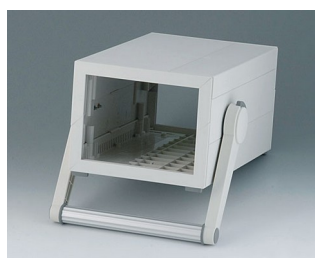
B2212317 MEDITEC E 220, avec poignée étrier ABS (UL 94 HB) gris blanc RAL 9002 160x260x124mm IP 40
