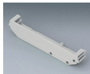
B6724333 RAILTEC SUP. 72, pièce terminale PA 6 (30) (UL 94 V-0) gris clair 82x11,2x16mm
