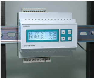
Appareils de mesure de la puissance pour l'analyse énergétique
