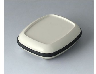
B1604217 BODY-CASE M, avec zone en creux ASA (UL 94 HB) blanc signalisation RAL 9016 50x41x14mm IP 65
