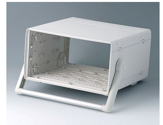
A0234470 EURO-BOITIER 42 T, avec poignée étrier ABS (UL 94 HB) gris blanc RAL 9002 260x250x143mm
