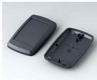
B9004808 Bottom and top part EM ABS (UL 94 HB) lava 68x42x18mm
