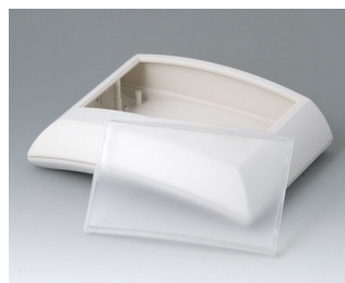
B7020247 ERGO-CASE L, плоский АБС (UL 94 HB) белый RAL 9002 150x200x54mm IP 40
