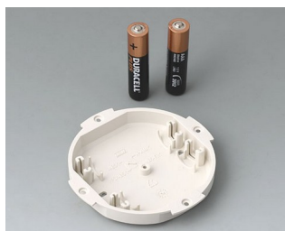
B5111107 Батарейный отсек, 2 x AAA АБС (UL 94 HB) белый RAL 9002
