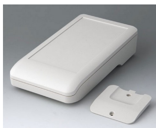
A9007207 DATEC-COMPACT L АСА+ПК (UL 94 V-0) белый RAL 9002 206x110x47mm IP 65
