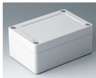
C7012011 IN-BOX АБС (UL 94 HB) светло-серый RAL 7035 122x82x55mm IP 66, IP 67, IK 07
