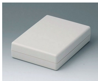
A9413331 SHELL-TYPE CASE G 190, исп. I ABC (UL 94 HB) белый RAL 9002 138x190x45mm IP 65 opt.
